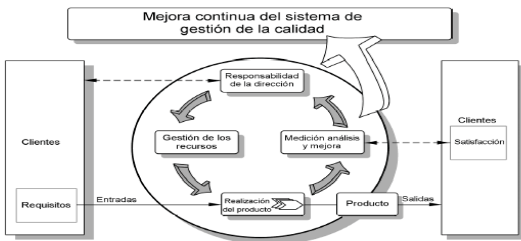
Figura 1.8 Modelo de un SGC basado en proceso. Fuente: ISO 9001:2008.
