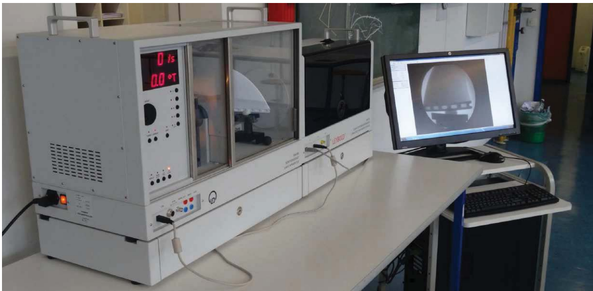
Abb. 07: Die Labor-Röntgenanlage der Beuth HS mit einer Surfboardfinne vom Stand der Technik ( FUTURES ).
