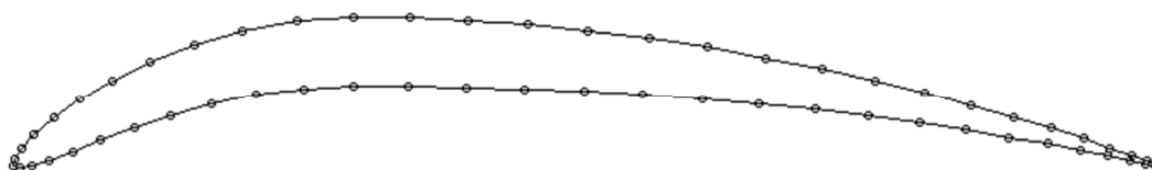
Abb.10: NACA-Standardprofile der 4er-Serie mit einer Dicke von 6% unter Variation der Wölbung bei konstanter Wölbungsrücklage.
