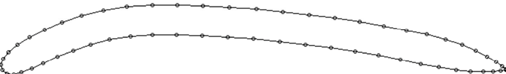
Abb.7: Plattenprofil mit einer Dicke von (d/t) = 6\% unter Variation der Wölbungsrücklage bei konstanter Wölbung von (f/t) = 5\% .
