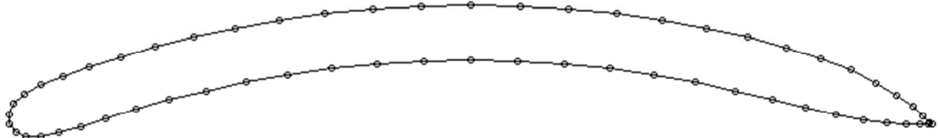
Abb.3: Plattenprofil mit einer Dicke von 6% unter Variation der Wölbung bei konstanter Wölbungsrücklage von (x_f/t) = 50\%
