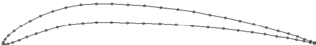
Abb.10: NACA-Standardprofile der 4er-Serie mit einer Dicke von 6% unter Variation der Wölbung bei konstanter Wölbungsrücklage.
