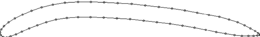
Abb.7: Plattenprofil mit einer Dicke von  $(d/t) = 6\%$  unter Variation der Wölbungsrücklage bei konstanter Wölbung von  $(f/t) = 5\%$ .
