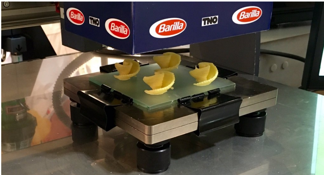
Abbildung 3.4 Nudel-3D-Drucker der Firma Barilla 85
