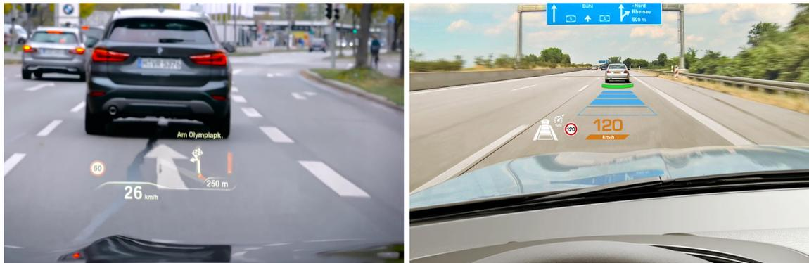
(a) Heutiges HUD (Bildausschnitt)<sup>40</sup>(b) AR-HUD der Zukunft (Bildausschnitt)<sup>41</sup>**Abbildung 3.3** Vergleich eines heutigen HUDs (links) mit einem AR-HUD der Zukunft (rechts)
