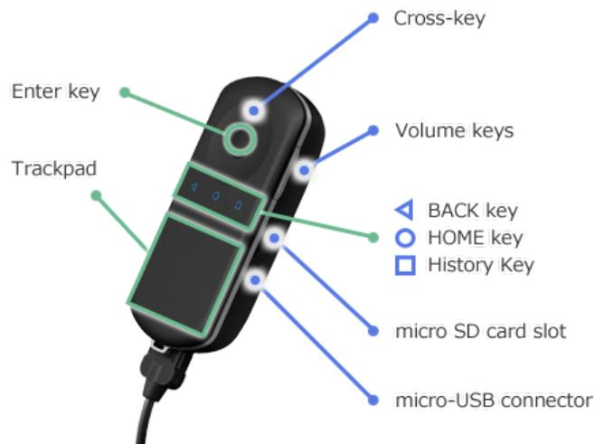
**Abbildung 4.4** Controller der Epson Moverio BT-300 (Bildausschnitt)<sup>134</sup>
