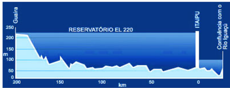
Abb. 6 Profil des Gefälle im Stausee von Itaipú Binacional (Quelle: www.itaipu.gov.py )
